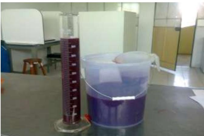
**Foto 5.** Medida en probeta de los grados Baumé y demás análisis en una muestra extraída durante la fermentación.
