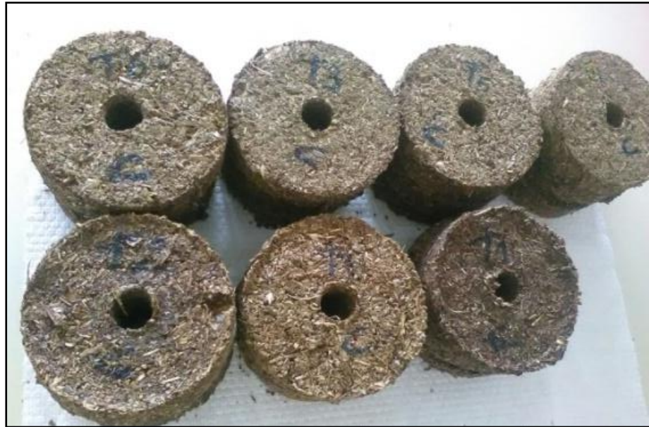
Anexo 4: Briquetas elaboradas a partir de residuos de poda de olivo y orujo de aceituna.
