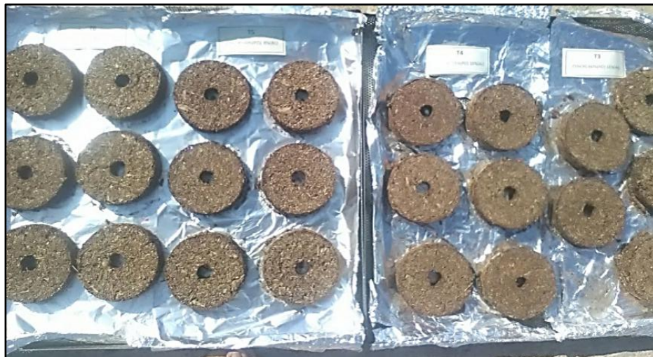
Anexo 3: Secado de Briquetas. Se utilizó bandejas de acero inoxidable forradas con papel aluminio sobre una superficie expuesta directamente al sol.
