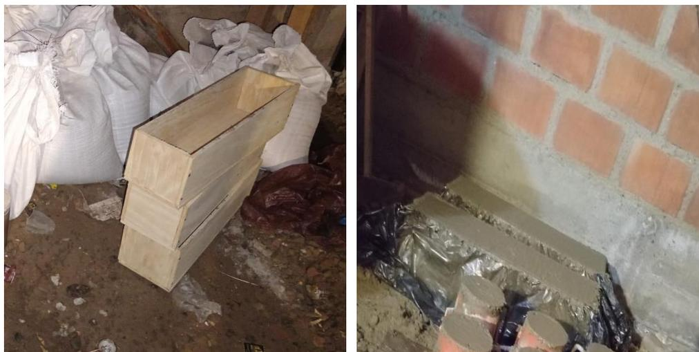
*Nota.* Manufactura de moldes prismáticos con concreto patrón y diferentes porcentajes de fibra de vidrio y aditivo superplastificante.
