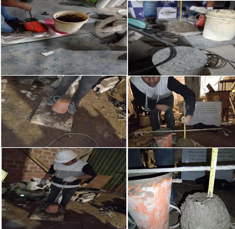
*Nota. En la figura se observa ensayo de slump con diferente porcentaje de fibra y aditivo superplastificante.*
