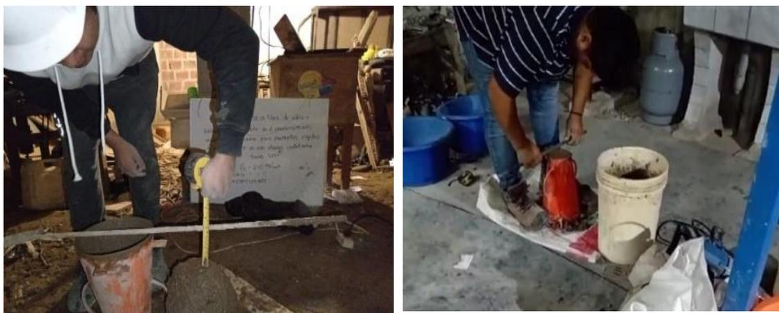
*Nota:* Se precisa el inicio de la operación hasta el término del ensayo. Este no debe pasar más de 2 min, luego el proceso de desmolde deberá ser lo más rápido, máximo 5 segundos.
