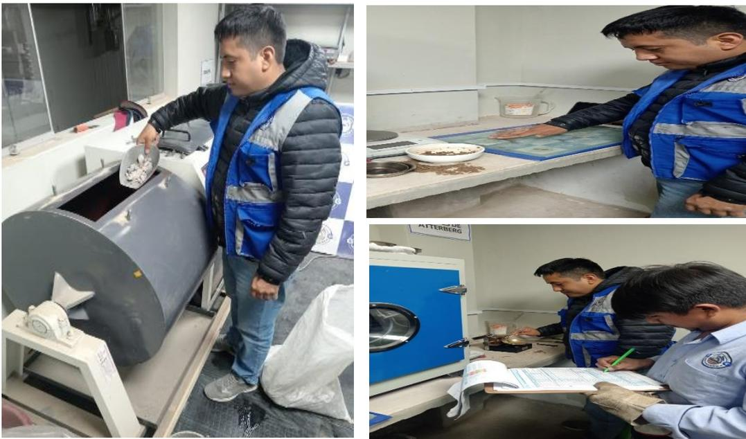
*Nota.* Se observa el desarrollo de abrasión ( desgaste de la piedra chancada de media) y ensayo de limite liquido y plástico del agregado grueso.
