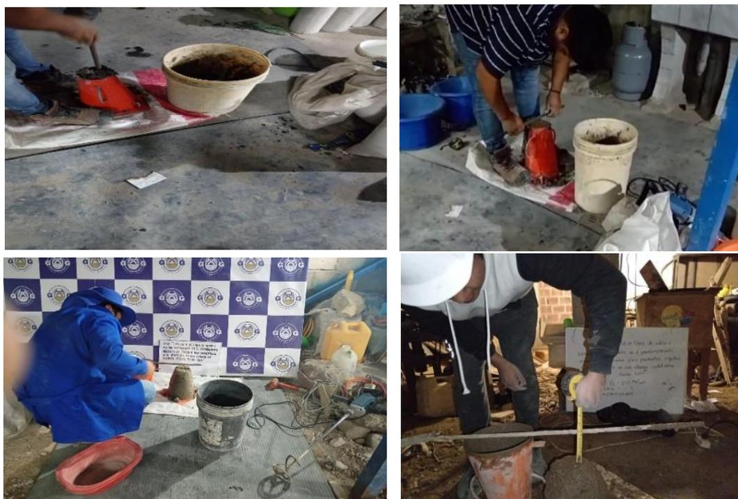
*Nota:* Se precisa el inicio de la operación hasta el término del ensayo. Este no debe pasar más de 2 min, luego el proceso de desmolde deberá ser lo más rápido, máximo 5 segundos.
