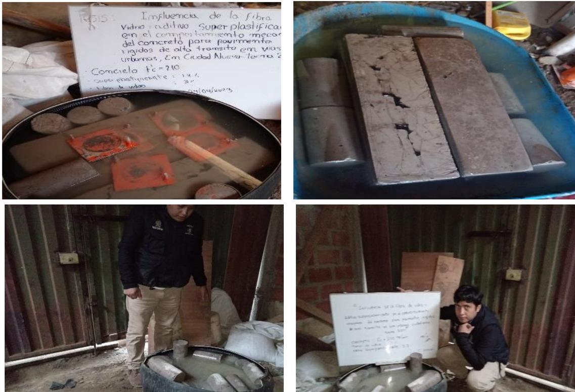
*Nota.* Se aprecia el curado de los probetas prismáticas y cilíndricas con diferentes porcentajes de fibra de vidrio y aditivo superplastificante a los 7,14 y 28 días.
