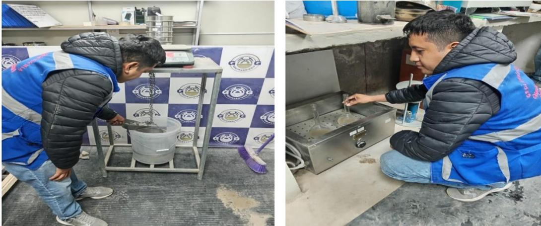
*Nota.* Desarrollo del peso específico y absorción del agregado grueso y peso específico de la piedra de chancada de media
