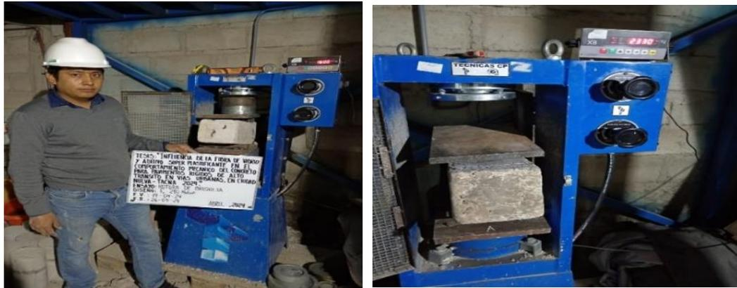
*Nota.* La figura muestra los experimentos de flexión llevados a cabo en el laboratorio utilizando distintas cantidades de fibra de vidrio y aditivo superplastificante.
