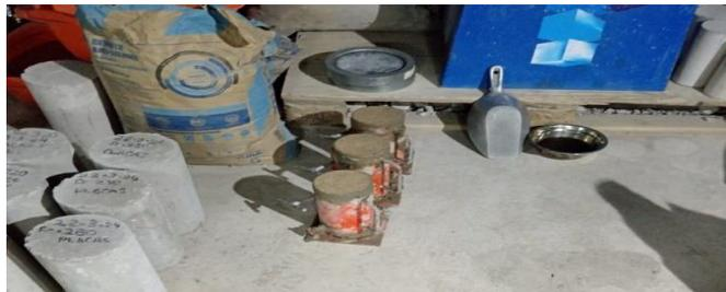
**Figura 13***Probetas cilíndricas con Adición de fibra de vidrio y aditivo superplastificante.*
