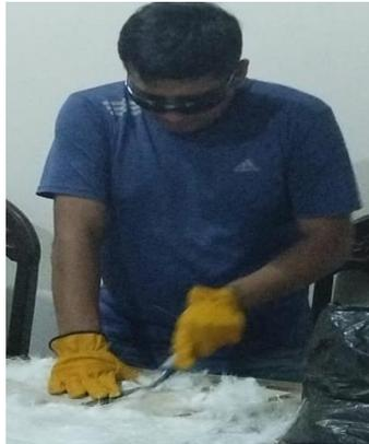
*Nota.* Corte de la fibra de vidrio en filamentos de 15 mm de longitud.
