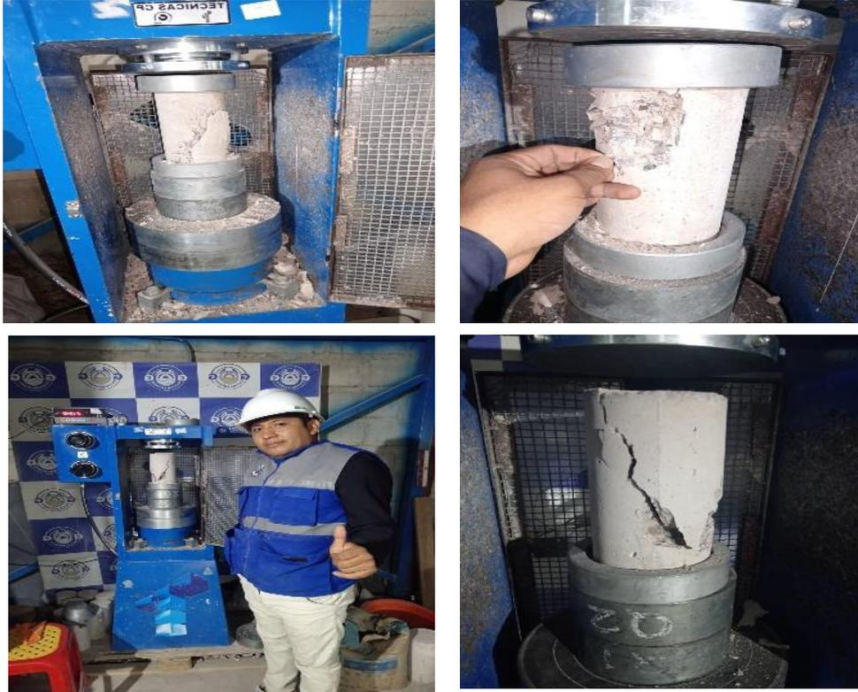
*Nota.* En la figura se aprecia rotura de briquetas con diferente tipo de fallas.
