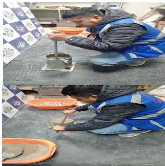
*Nota.* Desarrollo de los agregados y determinación del peso unitario compactado y suelto
