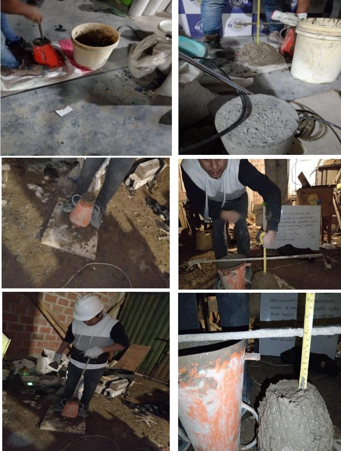
*Nota.* En la figura se observa ensayo de slump con diferente porcentaje de fibra y aditivo superplastificante.
