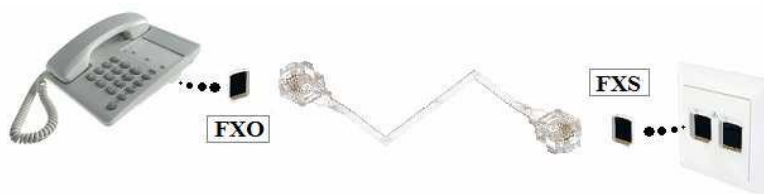
Figura 9. FXS /FXO sin centralita
