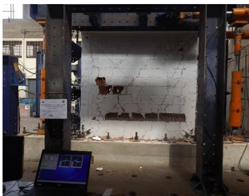
Figura – 29: Desprendimiento de ladrillos en la parte inferior central y Este de la cara Norte para una distorsión de 1/150.
