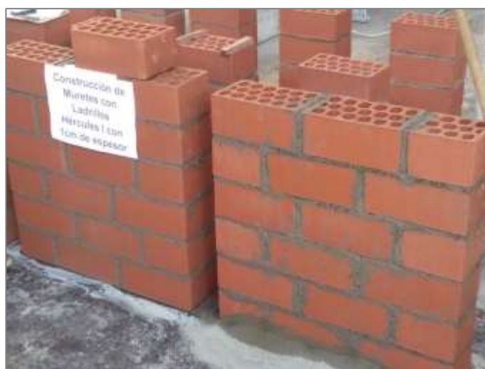
Figura 5. Muretes con Ladrillos Hércules I con 1 cm de espesor
