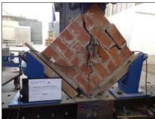
Figura 12. Falla por Deslizamiento en murete.
