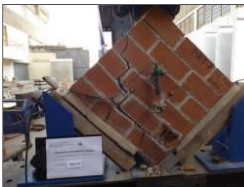
Figura 11. Falla escalonada en muretes.
