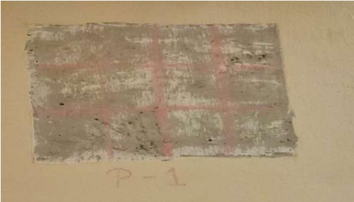
*Nota.* Se tomaron los 12 puntos para realizar el ensayo de Esclerometría.
