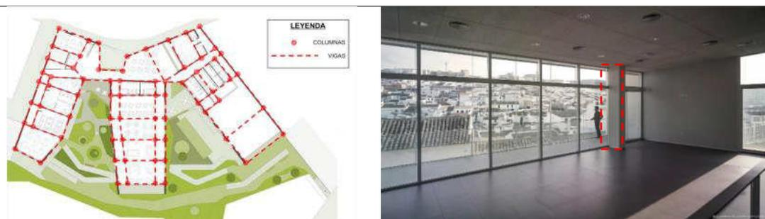
Modulación de la estructura consiste de vigas y columnas.
