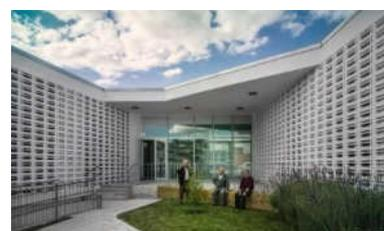
Se optó por utilizar un revestimiento compuesto por paneles de aluminio hueco de color blanco.
