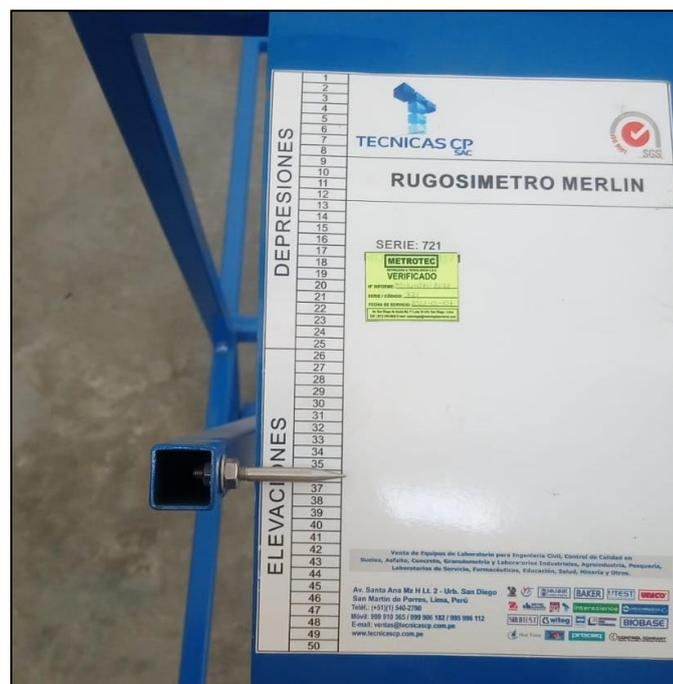
De igual forma se cercioró que la escala gráfica de 50 divisiones, que va adherida en el borde del tablero sobre el cuál se desliza el puntero, tenga un espesor de 5mm cada casilla, lo cual fue medido y corroborado (referido en la figura 35).
