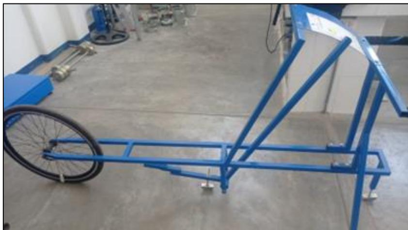
Se situó el rugosímetro en una superficie nivelada y se registró la lectura correspondiente a la ubicación del puntero cuando el patín móvil estaba en contacto con el suelo, siendo 25 la lectura, que marcó como posición inicial (referido en la figura 31).
