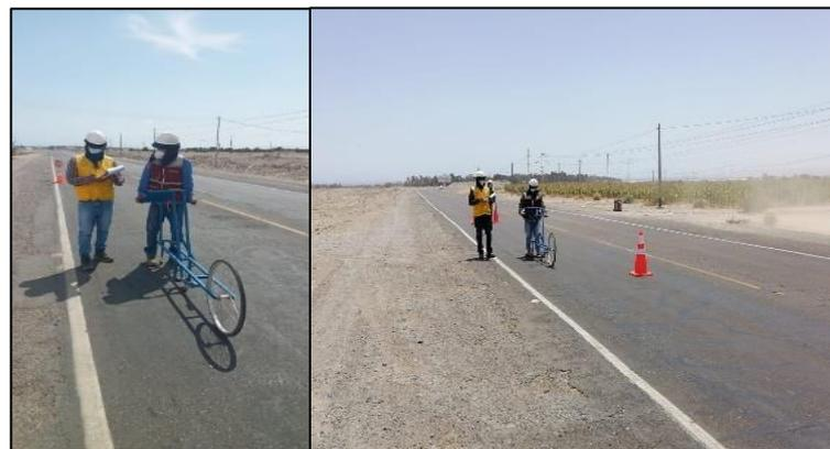
La Figura 82 muestra el termino del ensayo con el Merlin equipo para rugosidad en el km 5+000 en carril izquierdo concluyendo el estudio definitivo en la presente tesis.
