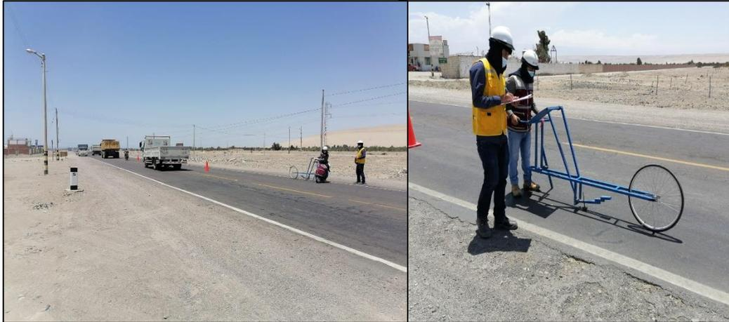
La Figura 72 muestra que al mismo tiempo 2 integrantes de la brigada de trabajo se encargan de brindar la seguridad cuando se efectuó el ensayo siguiendo la huella exterior del tráfico vehicular.
