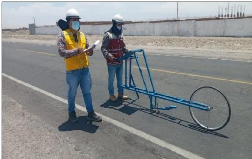
La Figura 75 demuestra el proceso de medición de las lecturas es de manera persistente a una velocidad promedio de 2 km/h en el kilómetro 6+000.
