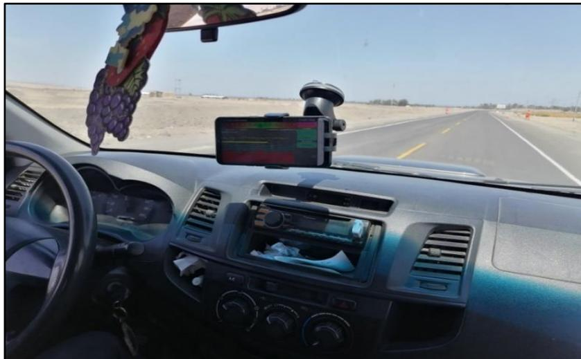
La Figura 66 muestra al vehículo marca Toyota, modelo hilux, carrocería pick up y año de fabricación 2014, para empezar, con el manómetro de presión digital se hizo la medición de presión de los 4 neumáticos a 25 psi, por último, colocamos una carga de 300 kilogramos, se seguirá considerando el peso adicional aproximado de 225 kilogramos del peso de 2 pasajeros y operador.
