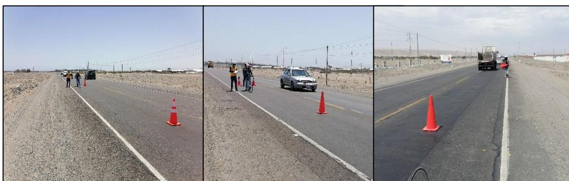
La Figura 80 muestra que se realizó el ensayo con el equipo merlin a una velocidad de 2 km/h continuo en la carretera investigación la Carretera Nacional: PE-
