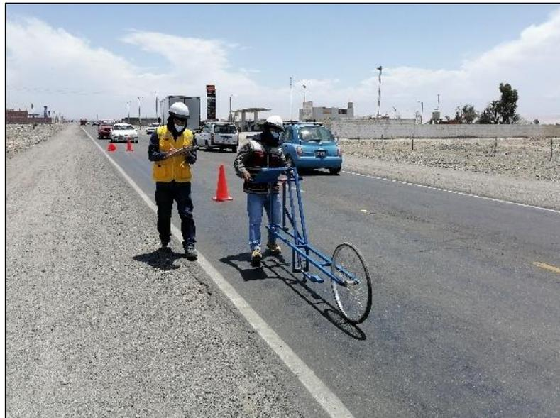
La Figura 74 demuestra que al momento de realizar las observaciones de las lecturas que recogerá el puntero del equipo Merlin para rugosidad estarán entre la escala 1 al 50 colocada sobre el tablero, por lo que se anotó en un formato en campo elaborado en cuadrículas compuesto por 20 filas y 10 columnas.
