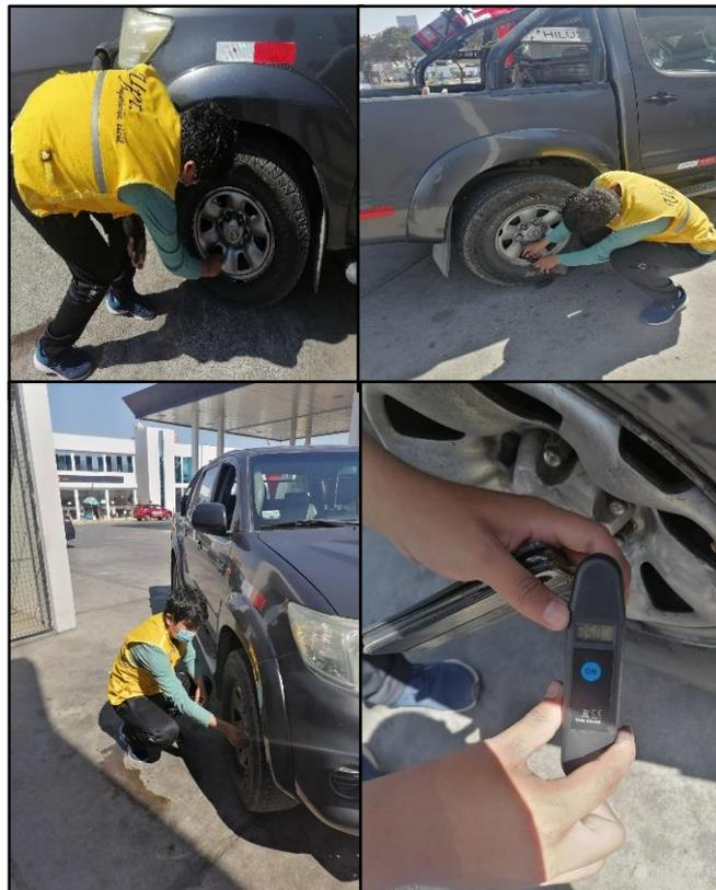
La Figura 60, señala al haber colocado una carga de 300 kilogramos, además se sumará el peso aproximado de 225 kilogramos del peso de 2 pasajeros y operador, luego tenemos que revisar si se encuentra activo los datos móviles y ubicación GPS en el smartphone Huawei P30 (Gama Alta) para determinar los resultados haciendo uso del aplicativo móvil ABAKAL IRI por ende realizar la combinación 9 – N° de viaje 17, se colocó el smartphone Huawei P30 suspendido del parabrisas.
