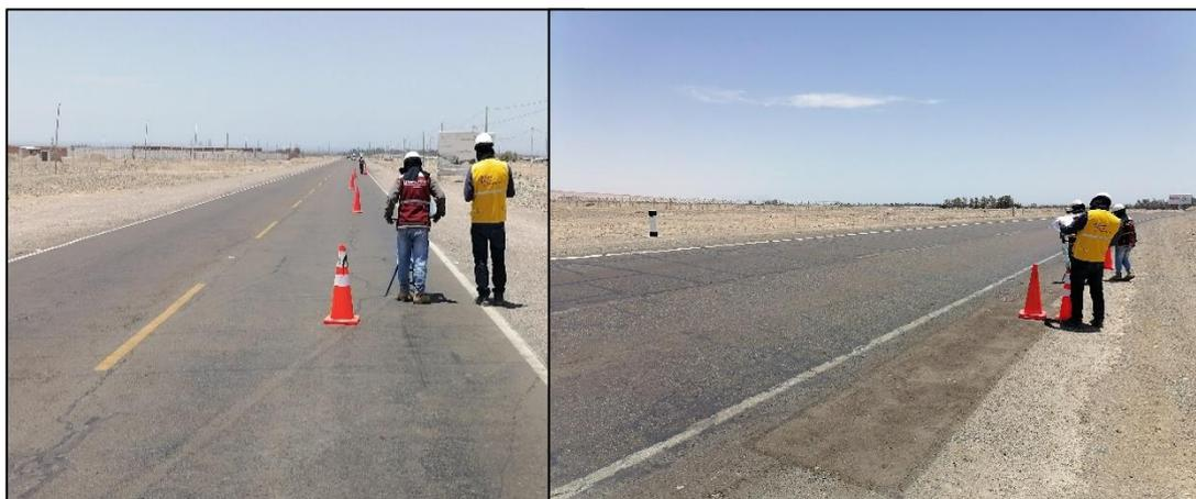
Se realizó seguidamente el ensayo con el equipo Merlin en el carril izquierdo (subida) en la Carretera Nacional: PE-1SD, La costanera, Tramo: Tacna (Provincia: Tacna) – Ilo (Moquegua) KM 7+000 AL KM 5+000. Ver Figura 57.
