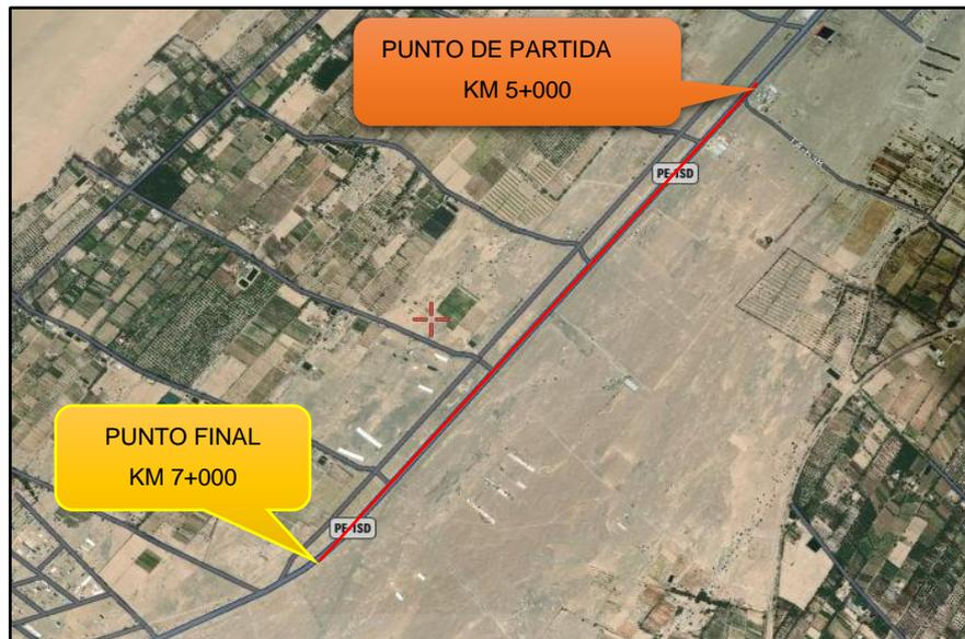
La Figura 51 nos guía que iniciamos la combinación 1 – N° de viaje 2, a una velocidad constante y centrada en los 80 km/h en el km 7+000 al km 5+000, realizamos al momento el uso del aplicativo ABAKAL IRI “iniciar” >” conteo”> al término del km 5+000> “parar”>” detener”>” guardar”.
