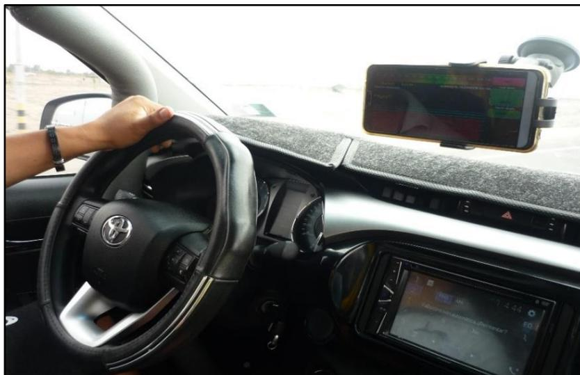
La Figura 53 muestra que con el uso del vehículo marca Toyota, modelo hilux, carrocería pick up y año de fabricación 2021, consideramos la presión de los 4 neumáticos con el manómetro de presión digital al rango de 35 psi, segundo, retiramos una carga de 300 kilogramos, se considerará el peso aproximado de 2 pasajeros y operador igual 235 kilogramos.
