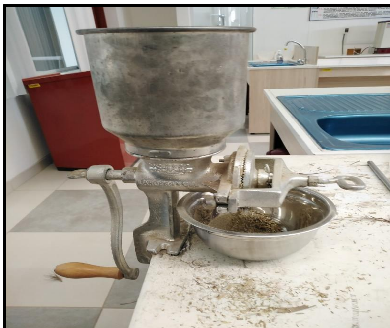
Figura 22. Molienda de la muestra seca en un Molino manual de hierro fundido.
