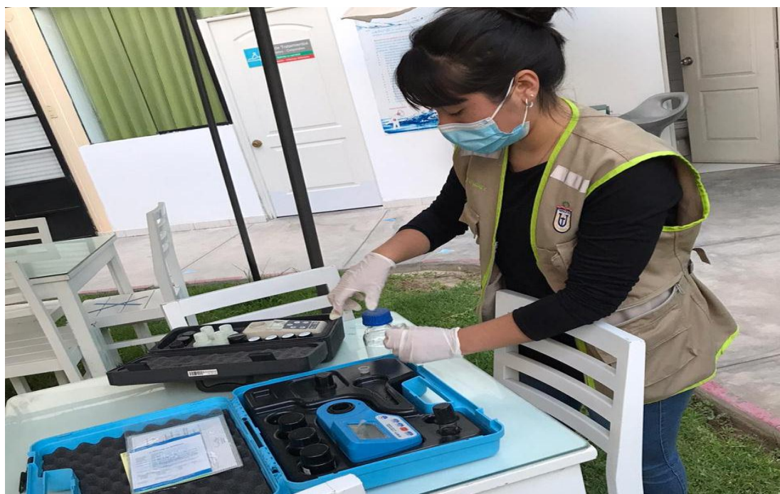
Figura 24. Análisis de Cloro Residual y Turbidez de Muestra de Piscina Arenas Hotel & Spa
