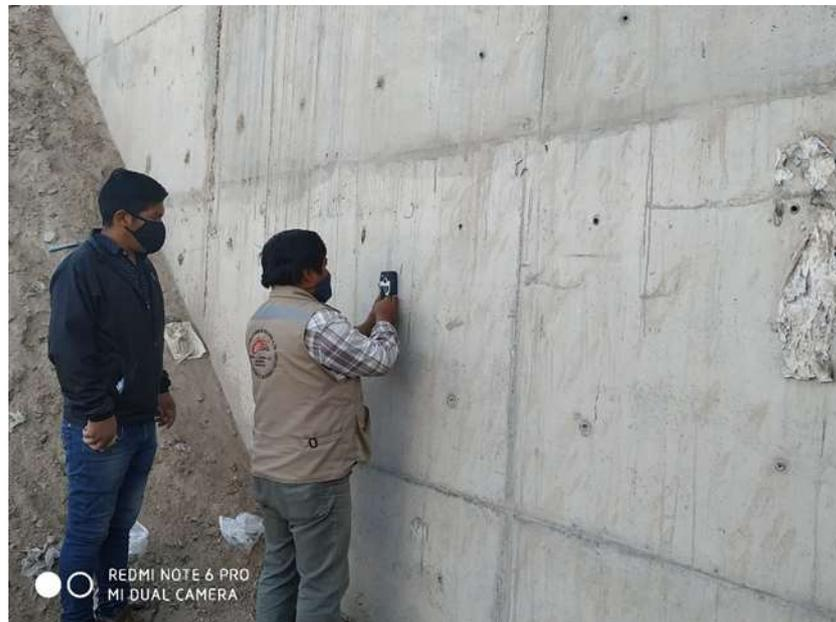
Figura 27: Búsqueda de zonas aptas para muestreo con ayuda del detector de metales.
