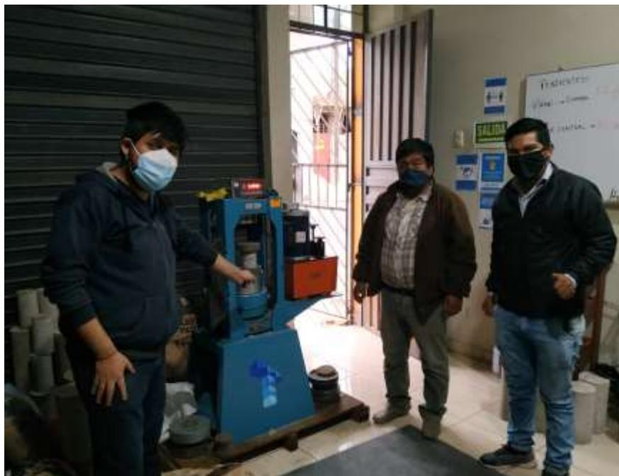
Figura 48 : Equipo de compresión de muestras cilíndricas de concreto propiedad del laboratorio TECOSUR S.C.R.
