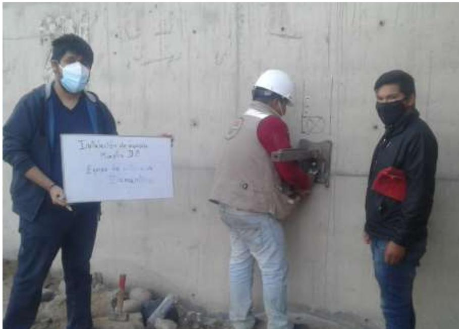
Figura 44 : Instalación del equipo de diamantina para la extracción de la muestra 02
