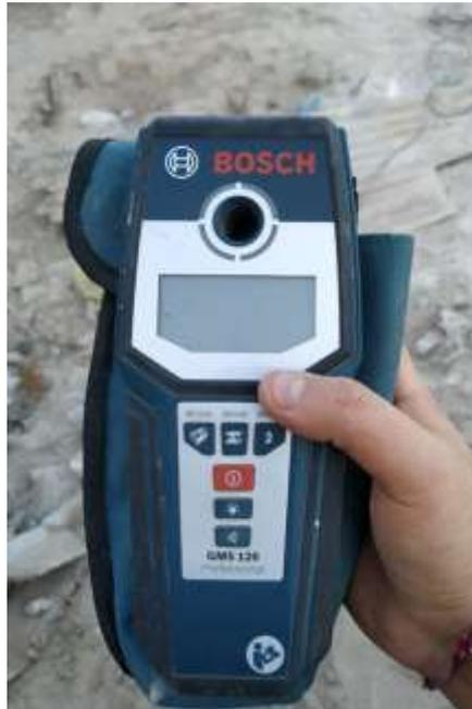
Figura 28 : Equipo detector de metales hasta 120mm.
