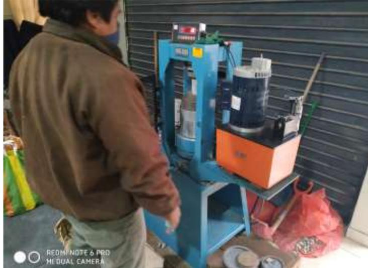
Figura 35: Ensayo de Compresión aplicado a los testigos de concreto M-D1 y M-D2
