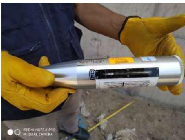
Figura 17: Valor de rebote de la Muestra 01 obtenida con el equipo Esclerómetro.
