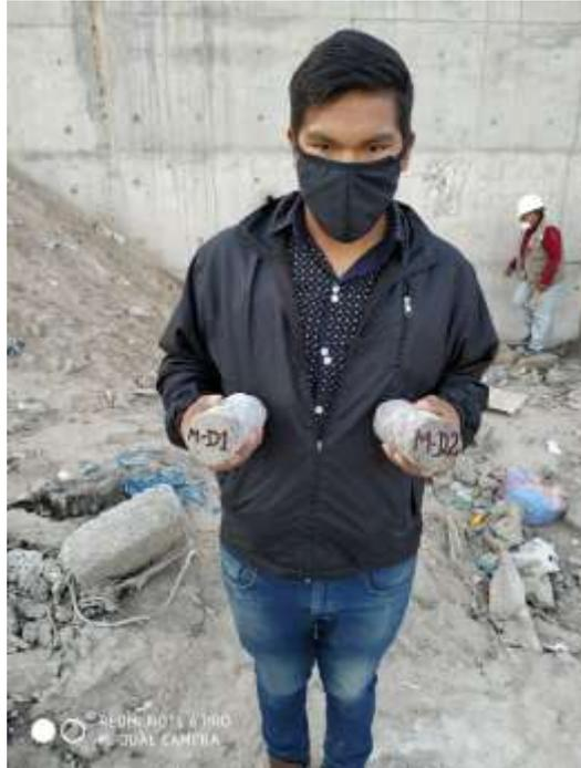
Figura 32;Muestra D1 y D2 extraídas con equipo de diamantina.
