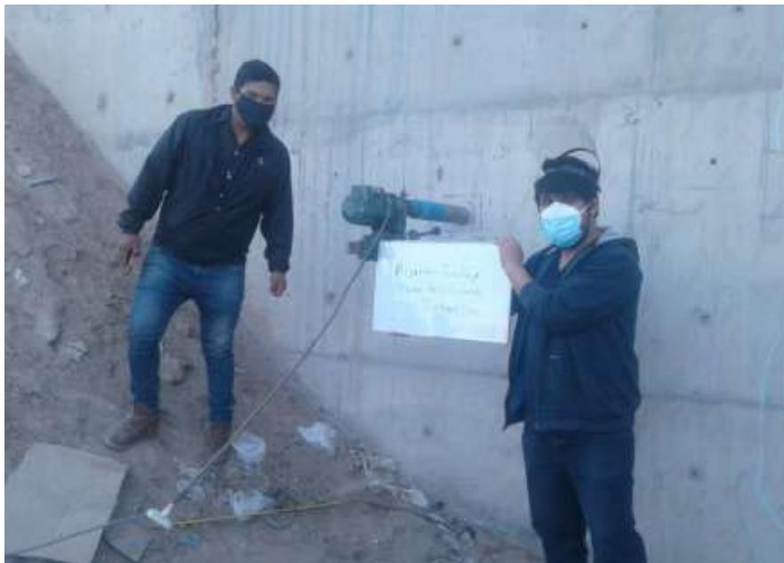
Figura 41 : Fijación del equipo de extracción de la muestra M-01 Diamantina en el muro de contención de estudio.
