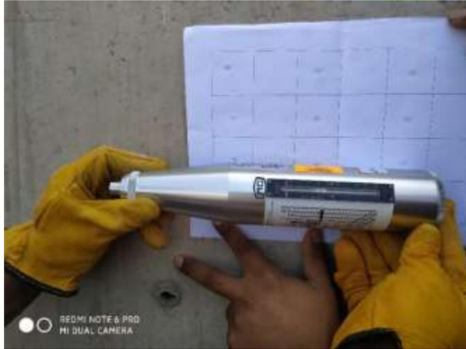
Figura 18: Valor de rebote de la Muestra 02 obtenida con el equipo Esclerómetro.
