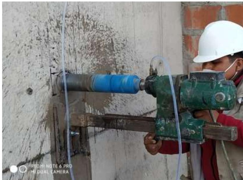
Figura 31: Extracción de Testigo circular de concreto con equipo de diamantina Muestra 01.
