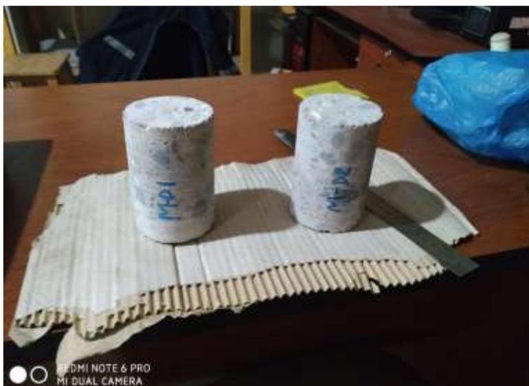
Figura 33: Testigos Circulares de Concreto Muestra D1 y D2
