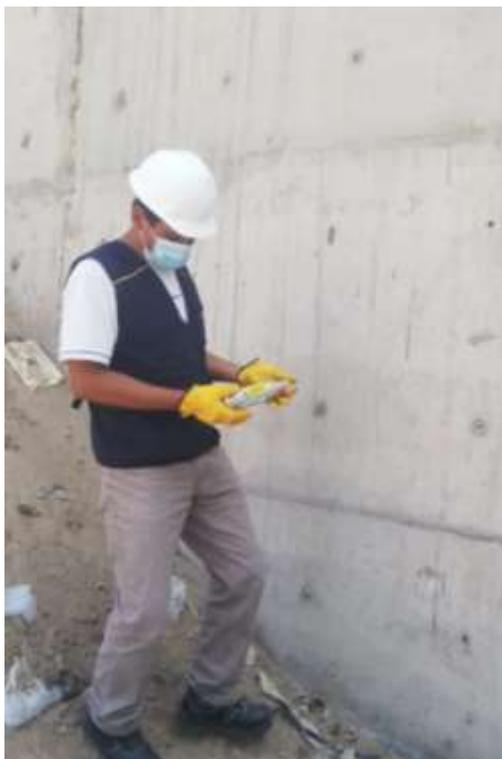
Figura 16: Toma de muestras con el equipo Esclerómetro.
