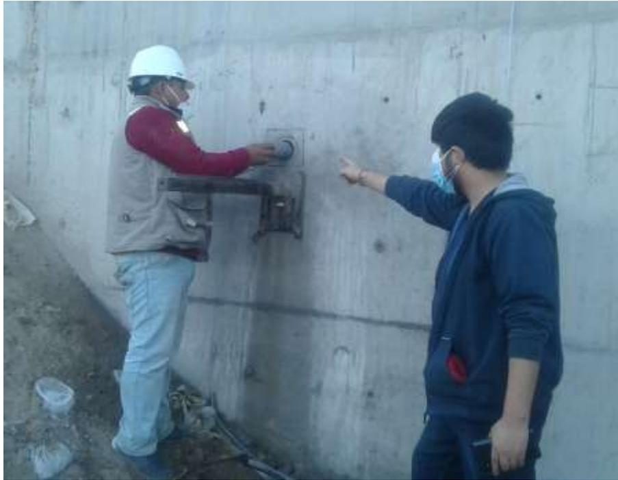
Figura 43 : Extracción de la muestra 01 del muro de contención.
