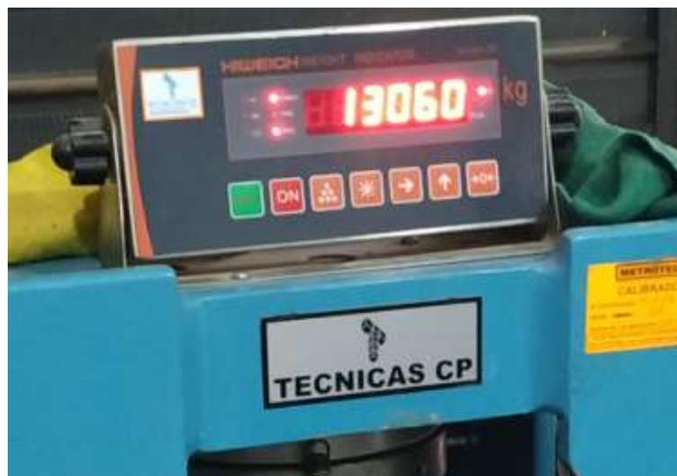
Figura 36 y 35 : Cargas Máximas registradas por el equipo de Compresión.
