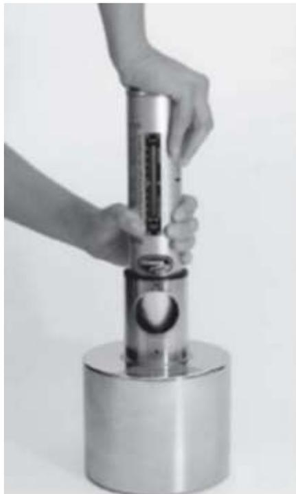
Figura 10: Yunque Tarado de acero para calibración del esclerómetro.
