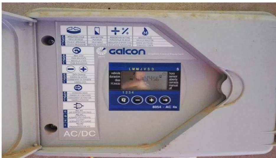
*Figura 38. Controlador de riego por temporizador*
