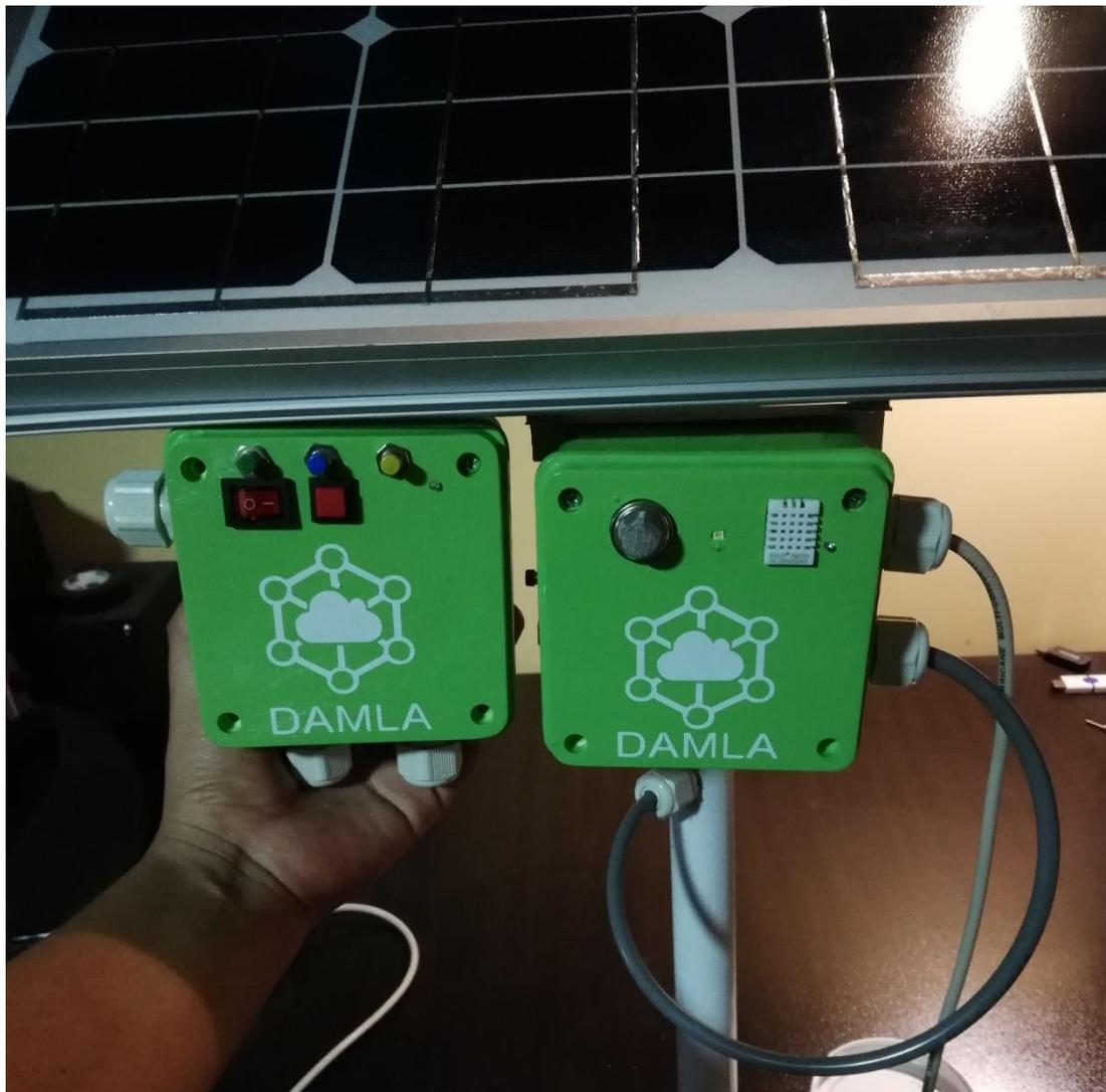
*Figura 27. Dispositivos Damla, Actuadores y sensores respectivamente*
