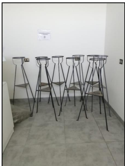
Figura 6 Soporte de los Colectores de Polvo.
