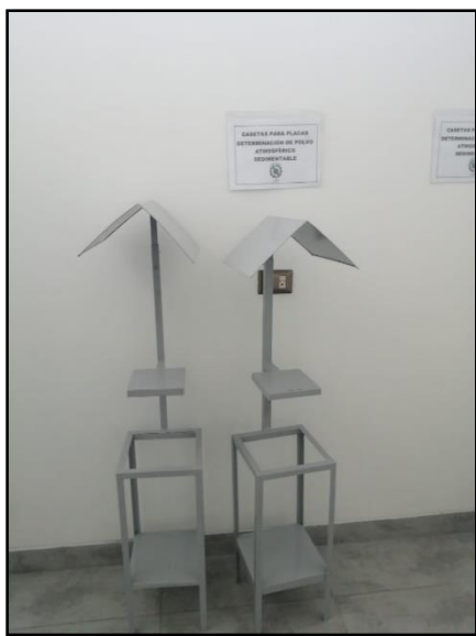
Figura 5 Casetas para Placas Receptoras.
