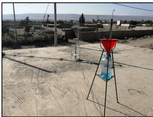
Figura 15 Casetas con Placa Receptora y Colector de Polvo, ubicados a unos metros de distancia.
