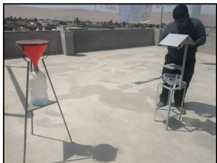
Figura 16 Casetas con Placas Receptoras y Colector de Polvo.
