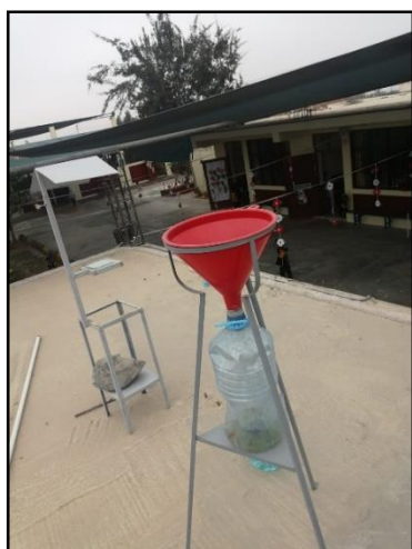
Figura 18 Caseta con Placas Receptoras y Colector de Polvo, ubicadas en el Jardín "Santa Rita".
