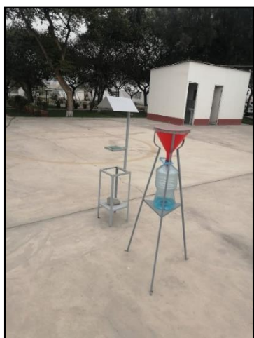
Figura 17 Caseta con Placas Receptoras y Colector de Polvo, ubicadas en la Dirección Regional de Educación.
