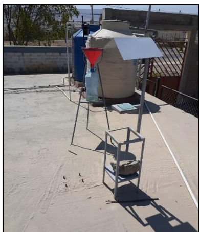
Figura 21 Caseta con Placas Receptora y Colector de Polvo, en el segundo mes de muestreo.
