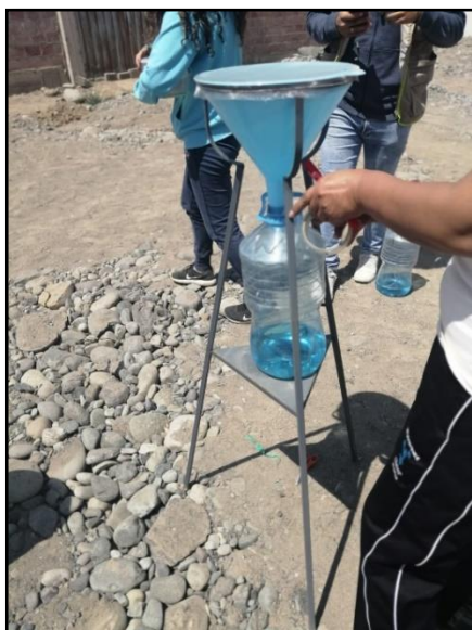
Figura 25 Instalación de Colectores de Polvo, asegurados con cinta para evitar la pérdida de muestra.
