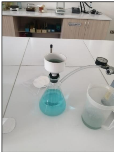
Figura 38 Filtración del agua recogida con embudo buchner y bomba de vacío.
