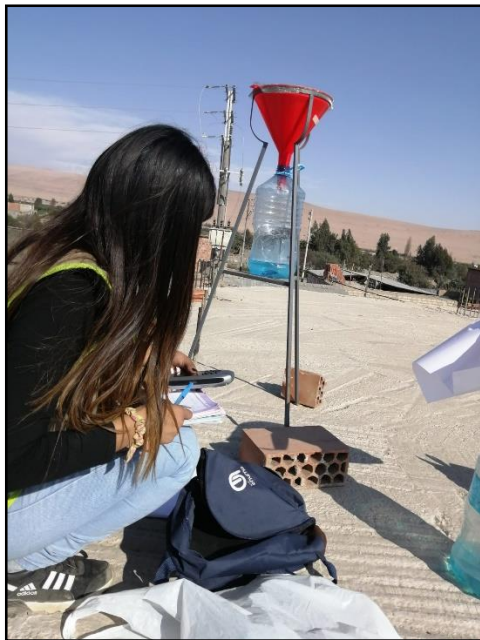
Figura 22 Toma de datos e instalación de los Colectores de Polvo en viviendas situadas en el distrito de Calana.
