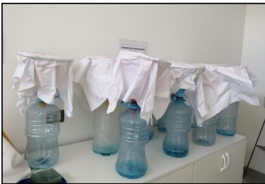
Figura 33 Colectores de Polvo trasladados al laboratorio.
