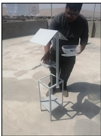
Figura 8 Instalación de las Placas Receptoras, en viviendas situadas en el distrito de Calana.
