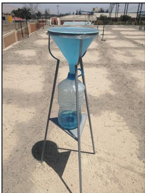
Figura 23 Instalación de Colectores de Polvo con malla metálica.
