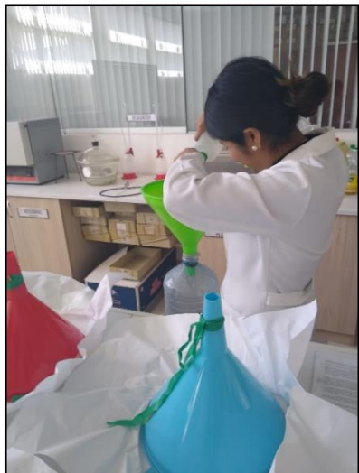
Figura 34 Colectores de Polvo en laboratorio, siendo lavados con agua destilada.
